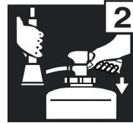
2. Schlauch fassen, Druckhebel kurz niederdrücken und loslassen.
